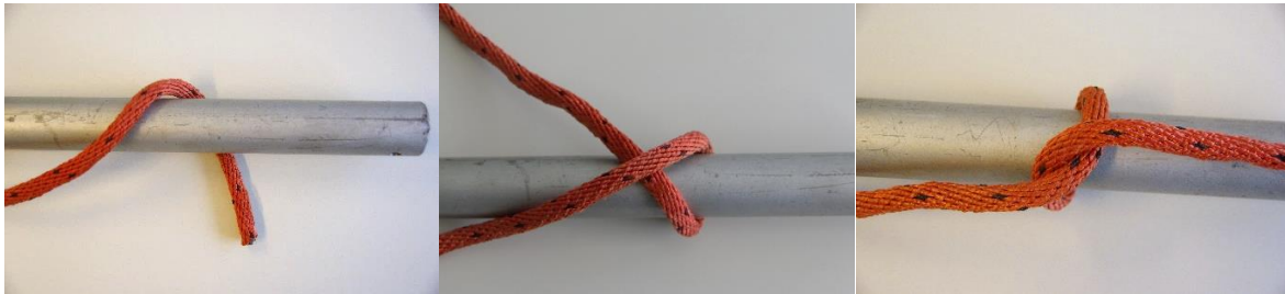
Abbildung 5: Stechen eines Halbschlags
