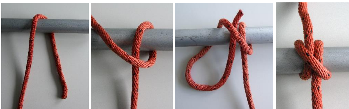
Abbildung 17: Stechen eines Mastwurfes
